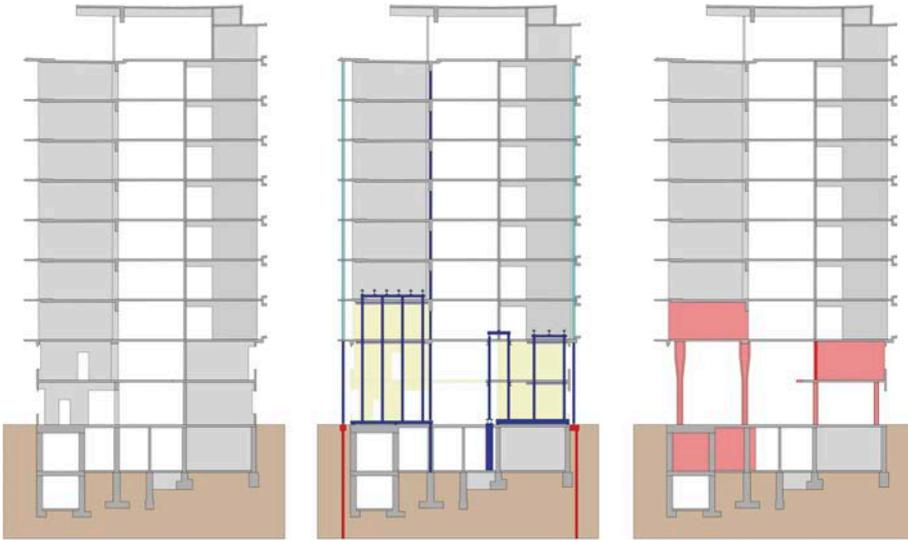
**Bild 9** Umbaukonzept Foyer: Bestand/Notsprießung und Abbruch/Neubau (Quelle: Dr. Lüchinger+Meyer Bauingenieure)
