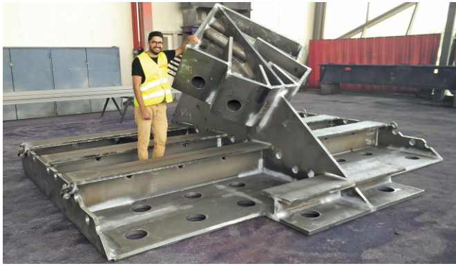
Bild 5 Stahleinbauteil zur Verankerung des vorgespannten Spannriings in den geneigten Eckscheiben Steel bracket for anchoring the prestressed tension ring in the inclined stadium corner slabs
