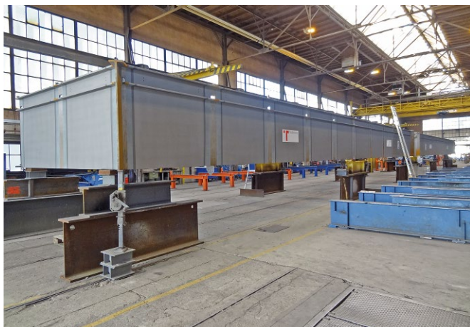
Bild 9 Fertigung der Einzelelemente des Trägerrosts Fabrication of the individual elements of the steel grid
